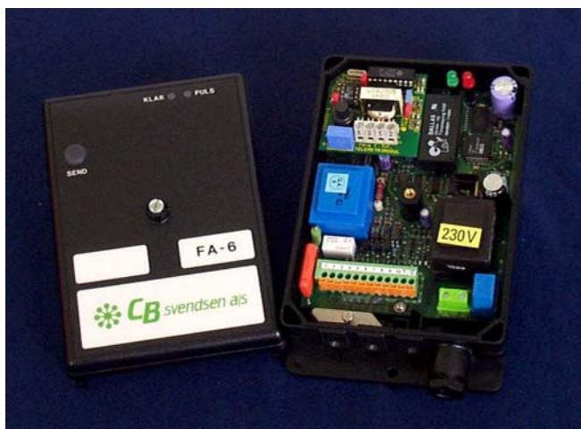
FA-6/TM er FA-6 med isat Telemetri modul
