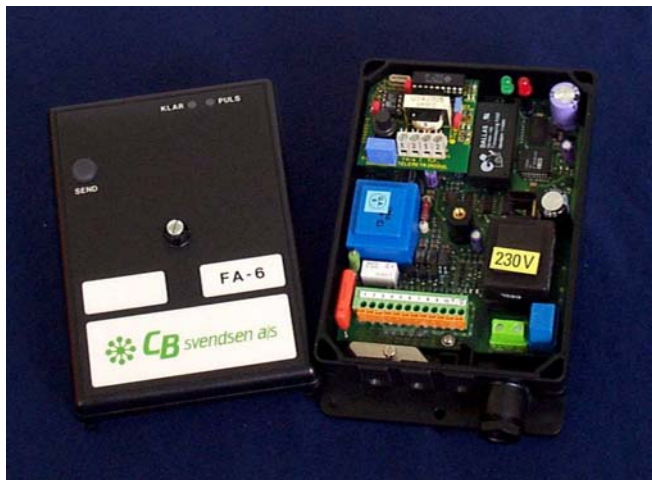
FA-6/TM er FA-6 med isat Telemetri modul
